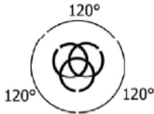
Drehen Sie die Pleuelagerbolzen so, dass die Öffnung des zweiten Ringes nach oben zeigt und die beiden anderen jeweils um 120° versetzt sind.
